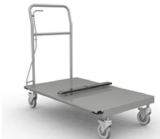
Chassy di base antitorsione in tubolari di acciaio inox AISI 304 (1.4301) saldati con procedimento TIG robotizzato; contorno perimetrale con profili in PEHD colore grigio fumo facente da paraurti, fissati direttamente sullo chassy. Corredato di n.4 ruote diam. 160x50 mm in gomma grigia antiraccia con cuscinetti a rulli inox, montate su supporti zincati, n.2 fisse e n.2 girevoli con freno di stazionamento a pedale, posizionate agli angoli.
