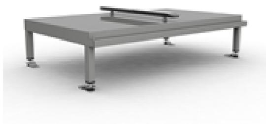
Châssis de base anti-torsion en tubes d'acier inoxydable AISI 304 (1.4301) soudés selon la procédure automatisée TIG ; contour avec profilés en PEHD. Équipé de 4 roues de 160 mm de diamètre en caoutchouc gris avec roulements à rouleaux en acier inoxydable; les roues, 2 fixes et 2 pivotants équipées d'un frein à pédale, sont disposées aux angles.
